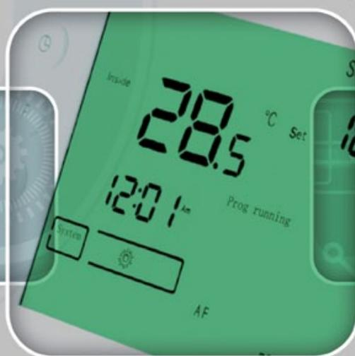
Il controllo della temperatura avviene nel punto che si considera più importante nella casa e il comando alla caldaia avviene in RADIOFREQUENZA. Gemini viene facilmente programmato e posizionandolo nel punto più opportuno trasmette in radiofrequenza il comando di accensione o spegnimento al ricevitore posto accanto alla caldaia o dove in origine sono stati fatti i collegamenti 2 fili con la caldaia.
