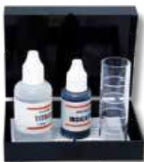
Per la misurazione della durezza dell'acqua.
