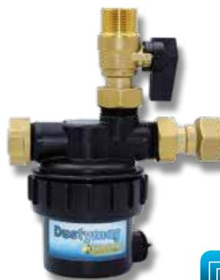
Il filtro defangatore magnetico sottocaldaia consente di eliminare sporco e detriti dal fluido termovettore che circola all'interno degli impianti di riscaldamento in tutte le installazioni in cui è necessario eliminare efficacemente le impurità. Il filtro defangatore magnetico sottocaldaia protegge e mantiene alla massima efficienza tutti i componenti presenti nell'impianto separando le impurità dal fluido termovettore facendo confluire tutti i detriti nel serbatoio di raccolta.
